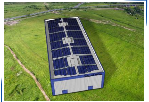
3D yerleşim planı çıkartılarak gölge analizi yapılır.
